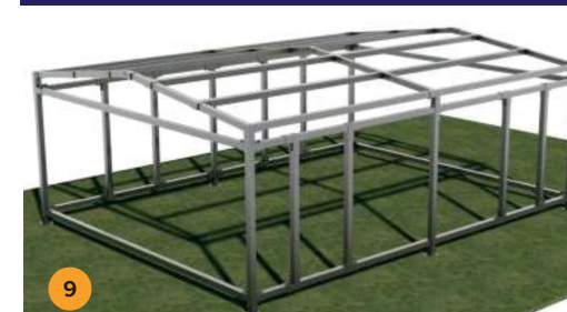
8 Instalación de los elementos de rigidización de la estructura en el plano Y.
