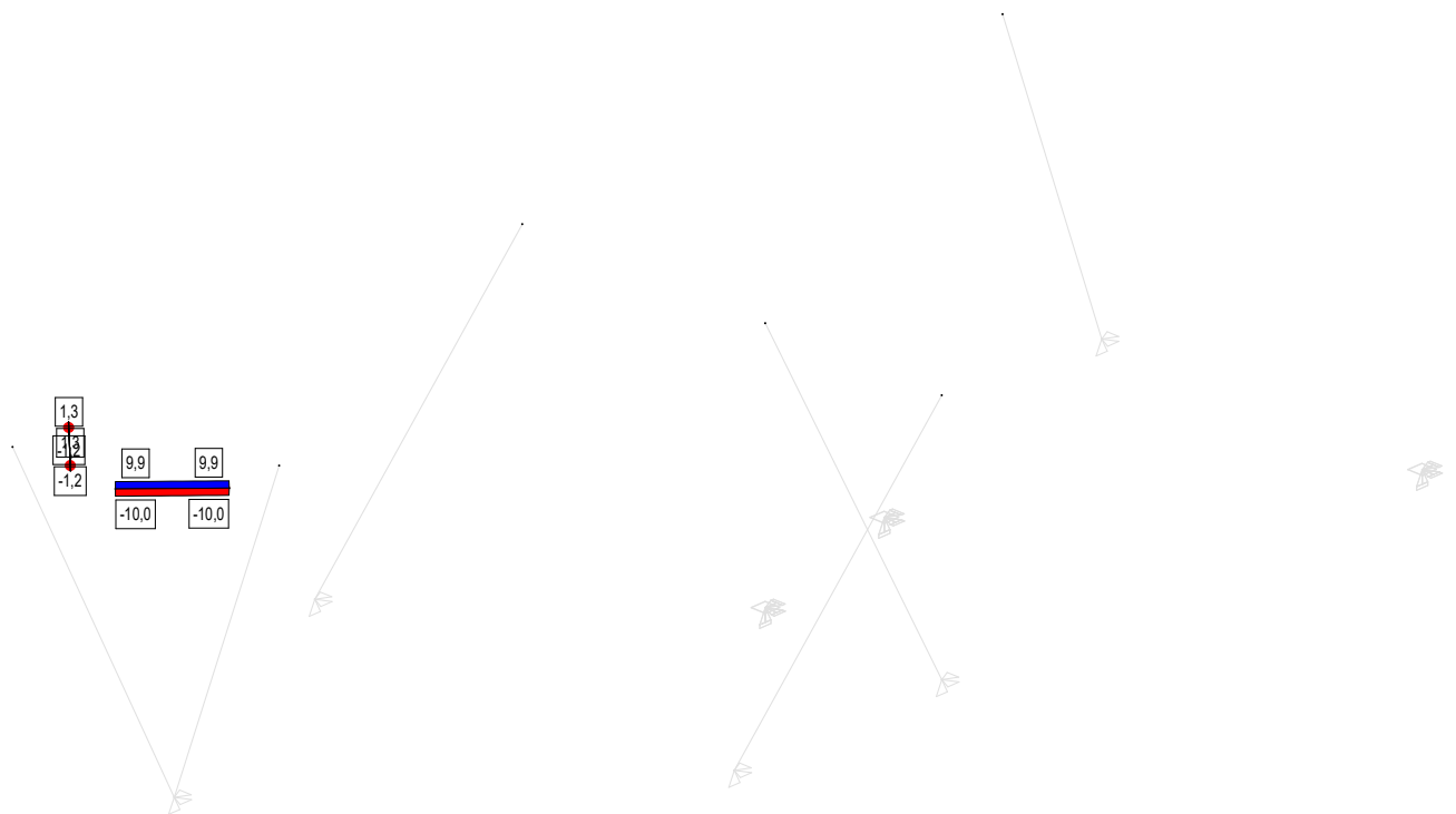
Esfuerzos axiales en cables de arriostrado
