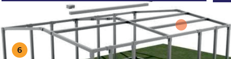
Montaje de las vigas “inter-pórticos” de cubierta
