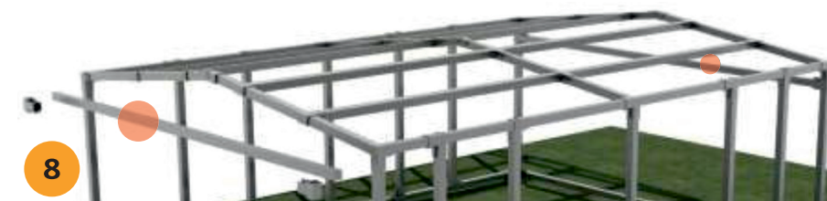
Instalación de los elementos de rigidización de la estructura en el plano Y.
