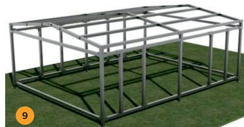
Instalación de los elementos de rigidización de la estructura en el plano Y.
