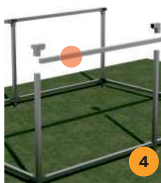
Montaje del Perímetro de cubierta, y formación de las dos aguas
