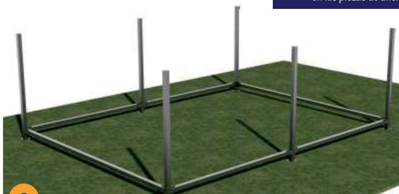
En este punto tenemos una base con cierta rigidez, e incluso podemos fijar la estructura al suelo mediante tacos u otro sistema de fijación.
