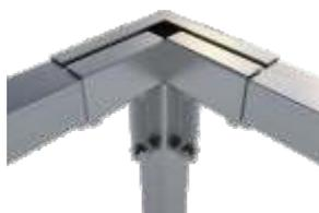
Piezas fabricadas en acero aleado de 3 mm, laminadas en frío y cincadas por galvanización en caliente. Con un tratamiento posterior de Pasivado Cromatizado
